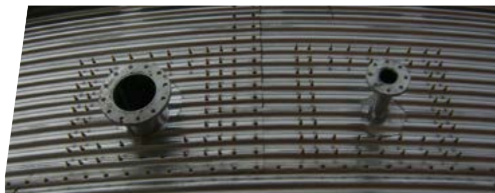
CONNEXIONS D'ENTRÉE ET SORTIE
