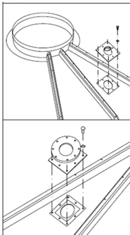
Capteurs de niveau máximo et mínimo et soutien
