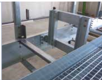
Halterungen für den Förderer, Feuerverzinkt mit Höhenverstellbarkeit.
